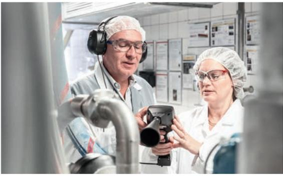
Regelmäßige Überprüfungen von Fabrik und Anlagen helfen, den Energieverbrauch zu senken. Reinhard Borowczak und Dagmar Preis-Amberger prüfen hier die Druckluftleitungen mit einem Detektor, um undichte Stellen zu identifizieren.
